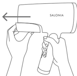
※ユニットが外れにくい時は、ユニットの▲マークを両手の親指で押さえて力を入れ、ゆっくりと押し出すようにして取り外してください。
