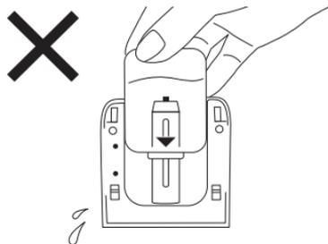
③ユニットをドライヤー本体に戻します。ユニットと本体の凹凸を合わせながら、カチッと音がするまで差し込んでください。
