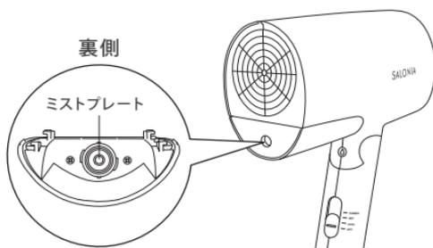
クリーン用カートリッジでミスト吹出口のお手入れ後に、専用のサロニアトリートメントミストドライヤーセラム【別売】と付け替えた直後は、フィルターに残った水道水が吹き出します。1分～2分程度ミストを吹き出してからご使用ください。
