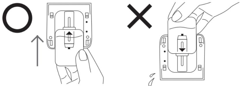
③ユニットをドライヤー本体に戻します。ユニットと本体の凹凸を合わせながら、カチッと音がするまで差し込んでください。
