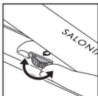
電源／温度調整スイッチのダイヤルを回して希望温度に設定します。設定温度に到達すると通電ランプが緑に変わり点滅が止まります。
