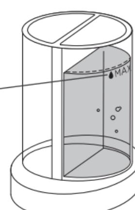
③吸引パイプをタンクの水注入側に入れて、タンクを水平にして取り付けてください。
