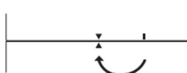
②本体背面の目印(▼)とタンクの目印(▲)を合わせるようにタンクを回して取り付けてください。
