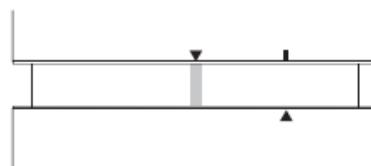
①タンクの縦線に、本体背面の目印(▼)を合わせるように差し込んでください。
