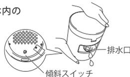
⑥ 給水タンクの水を捨て、本体や給水タンクに付着した水滴をタオルなどでふき取る。
