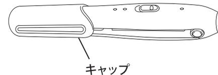
付属のキャップを取り付けて、プレートを閉じます。
